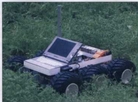
Bild 2. Bei der „Outdoor-Versuchsplattform“, mit der die Sensorik für die Erfassung der Umgebung erprobt werden kann, sorgen Komponenten des VolksBot für die Navigation und die Auswertung der Sensordaten.
