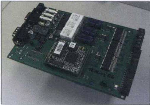
Bild 3. Mit der Motorcontroller-Platine TMC 200 lassen sich bis zu drei 200-W-Gleichstrom-Motoren ansteuern. Der Controller kann auch in anderen Anwendungen als kostengünstige Motoransteuerung eingesetzt werden.
