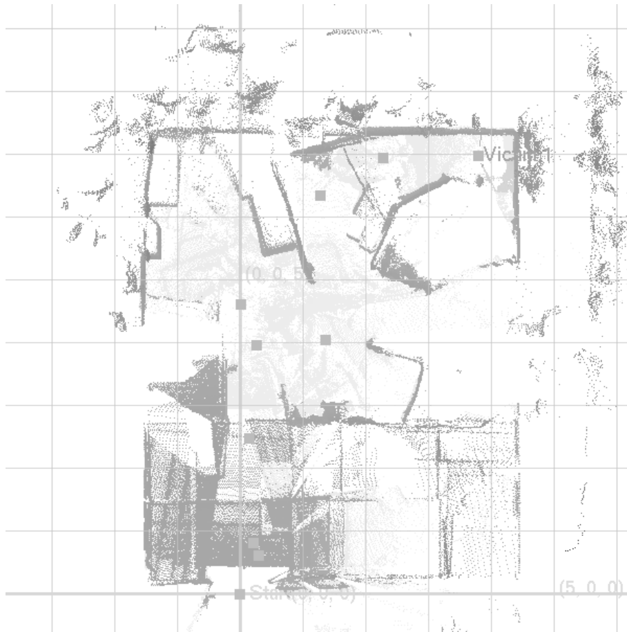
Abb. 2: Draufsicht auf ein automatisch vom Roboter aufgenommenes 3D-Modell während des RoboCup Rescue Wettbewerbs 2004.
